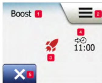
Mit der Betriebsart „**Boost**“ kann die Heizung eine Stunde lang konstant aktiviert werden. Nach einer Stunde wechselt der Raumthermostat zurück in den planmäßigen Betrieb.
