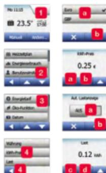
Mit dieser Option können die für die Energieverbrauchsrechnung erforderlichen Daten eingegeben werden. Die „**Energieverbrauch**“-Funktion verwendet diese Information zur Berechnung des Stromverbrauchs und der Heizkosten für einen gegebenen Zeitraum.
