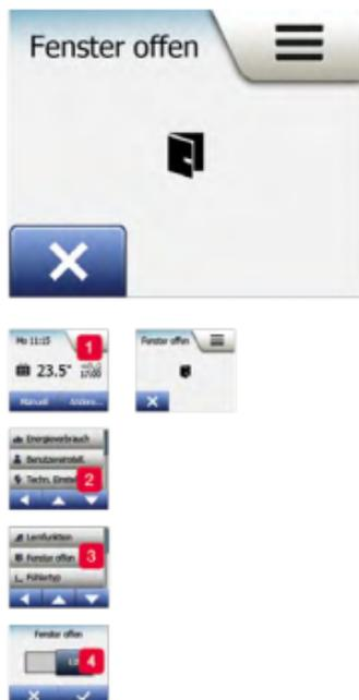
Der Raumthermostat kann, wenn er einen raschen Temperaturabfall registriert, ein offenes Fenster erkennen. Bei aktivierter Funktion schaltet der Raumthermostat, wenn ein offenes Fenster erkannt wird, die Heizung für 30 Minuten aus.
