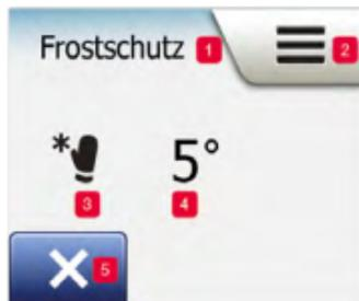
Die Betriebsart „**Frostschutz**“ dient dazu, bei nicht benötigter Heizung die Temperatur über dem Gefrierpunkt zu halten, bis dies manuell geändert wird.
